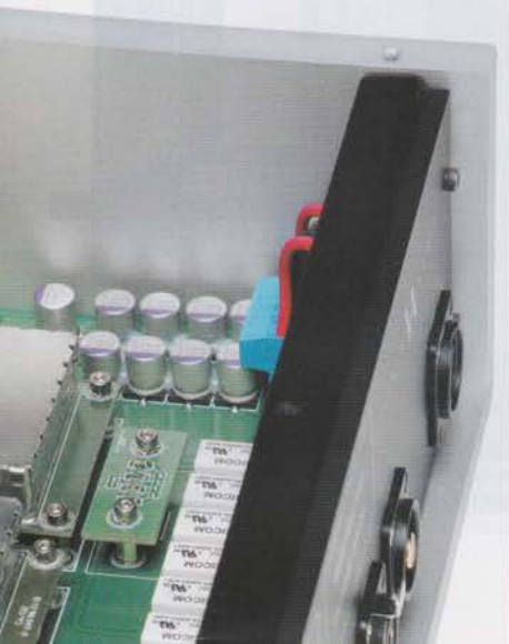
Die beiden Schrauben halten das austauschbare Widerstandsmodul zur Eingangsanpassung
