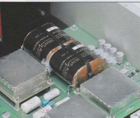
Die einzigen Kondensatoren, die Vitus im Signalweg duldet: Duelund-Kupferfolien
